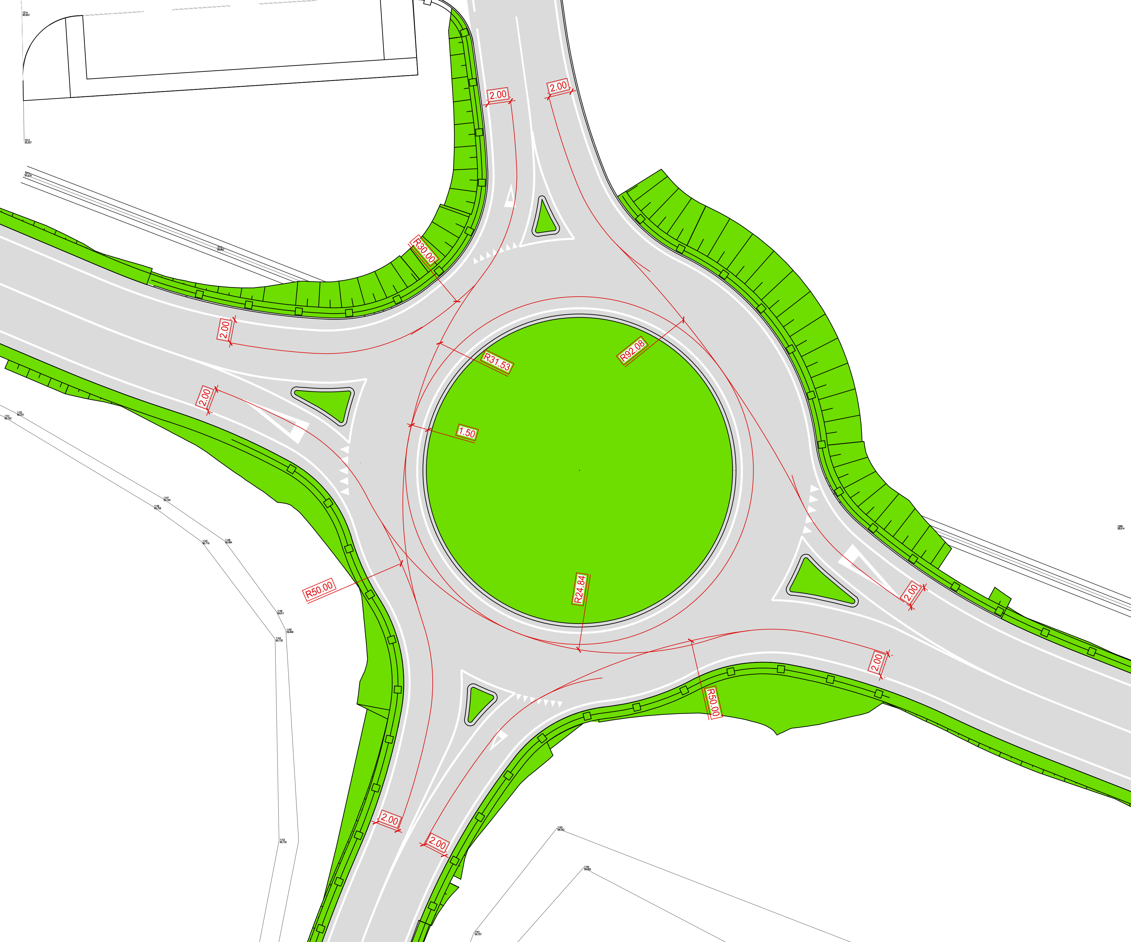
INTERSEZIONE A ROTATORIA - VERIFICA RAGGIO DI DEFLESSIONE
