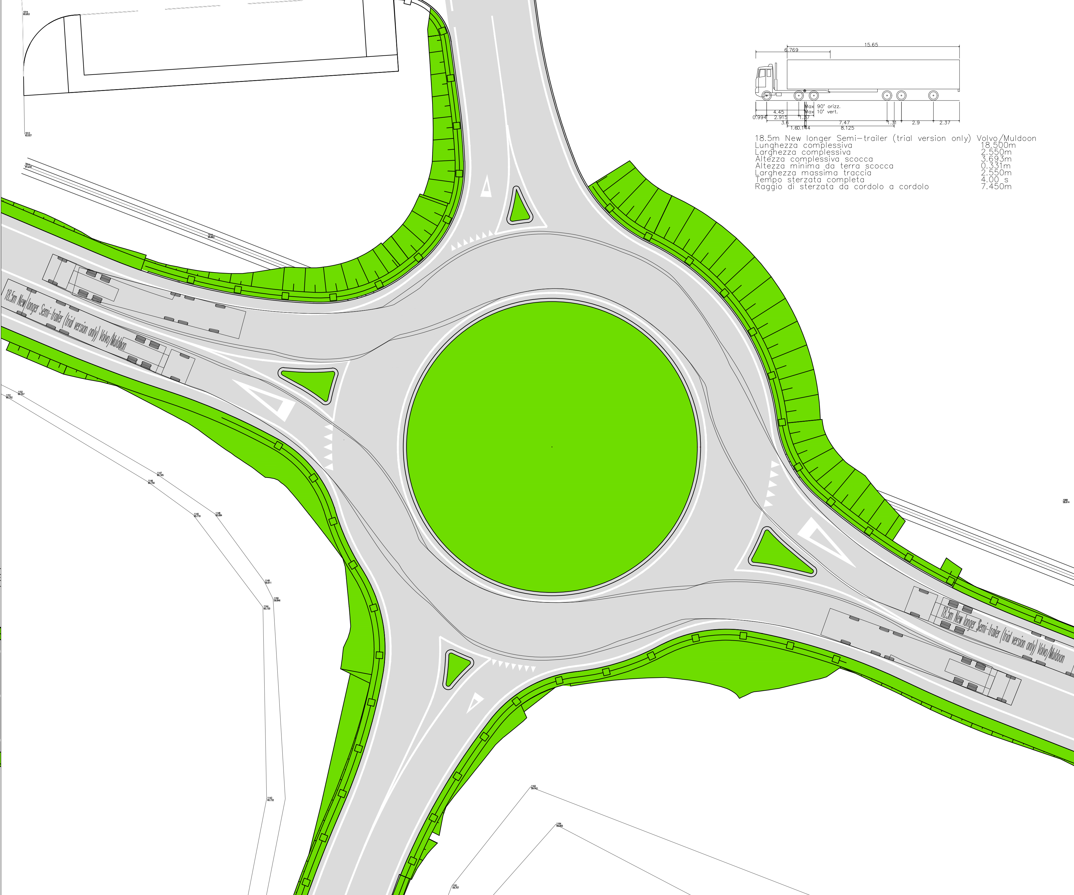
INTERSEZIONE A ROTATORIA - VERIFICA TRAIETTORIE MEZZI PESANTI
