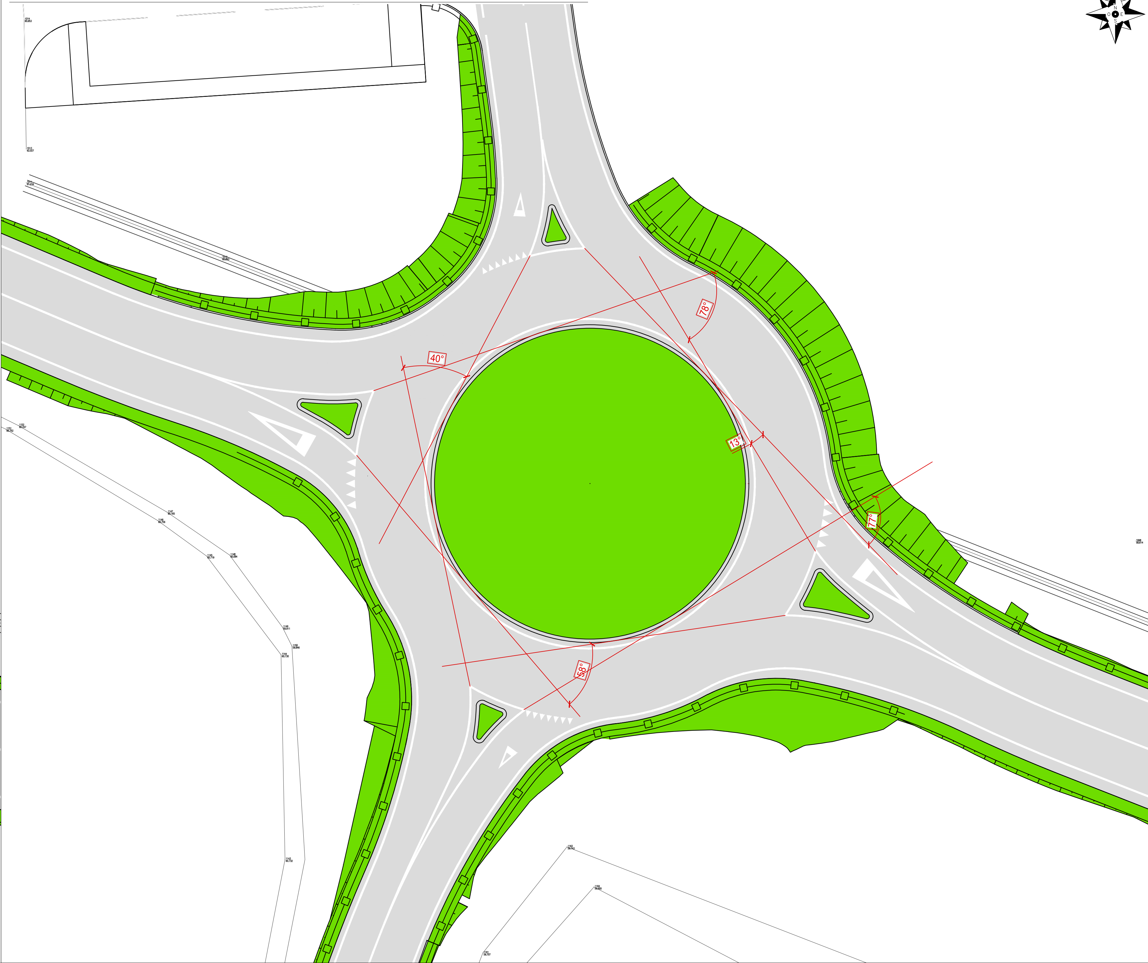
INTERSEZIONE A ROTATORIA - VERIFICA TRAIETTORIE MEZZI PESANTI
